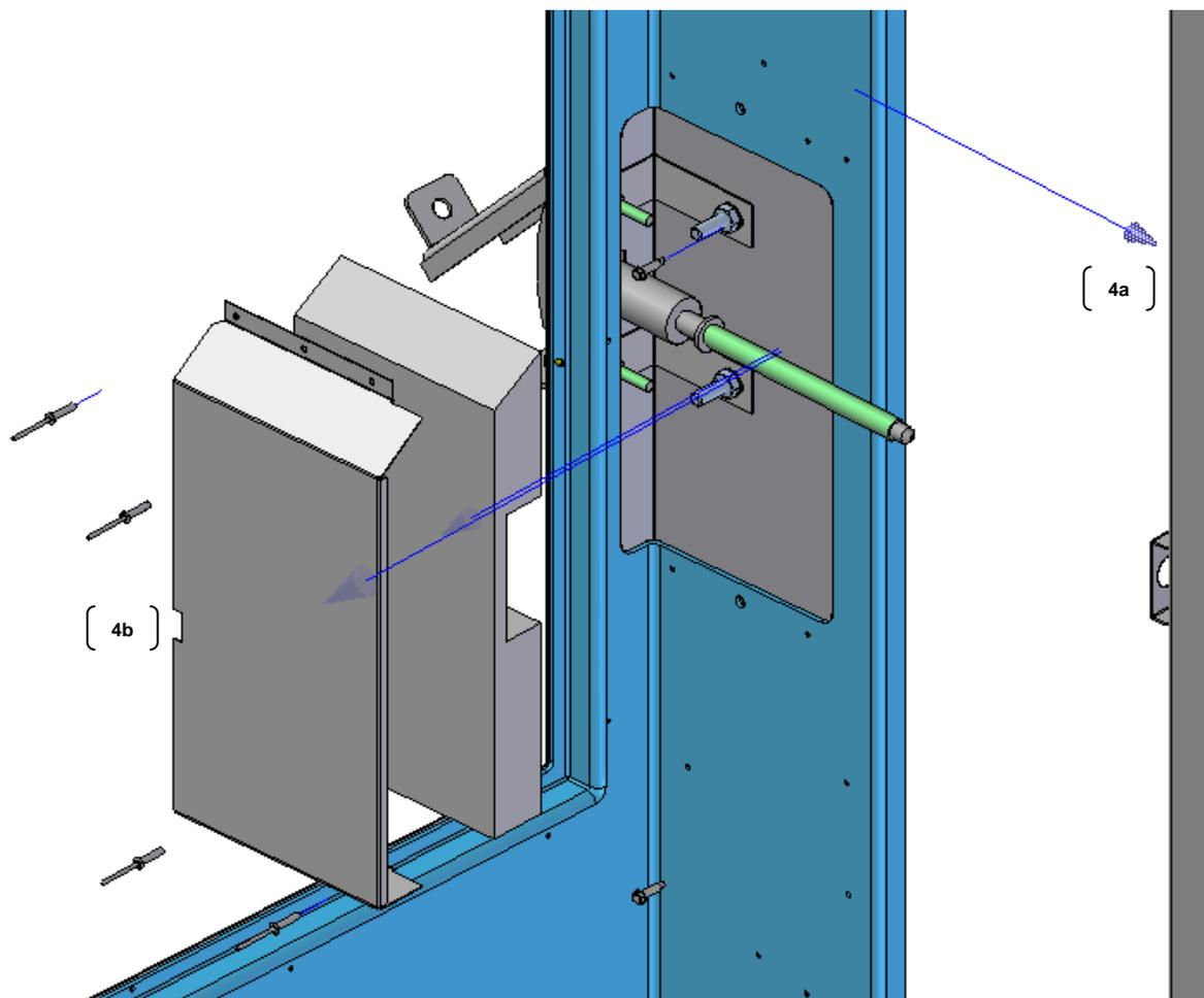
5. Coloque la plantilla por la parte externa de la puerta. Coloque los tornillos cabeza de coche que recién retiró en los dos barrenos centrales de la plantilla. (5)
