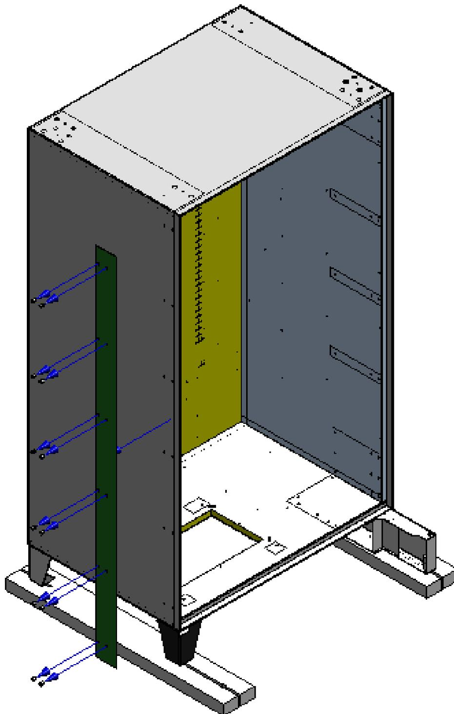
7. Coloque un panel antivandalismo interior en la puerta, alineándolo con los barrenos. Después coloque el panel antivandalismo exterior encima del panel antivandalismo interior, alineándolos con los barrenos. Apriete ambos paneles a la puerta utilizando los remaches de aluminio largos con ayuda de una remachadora grande. Asegúrese de que ambos paneles están firmemente sujetos a la puerta.
