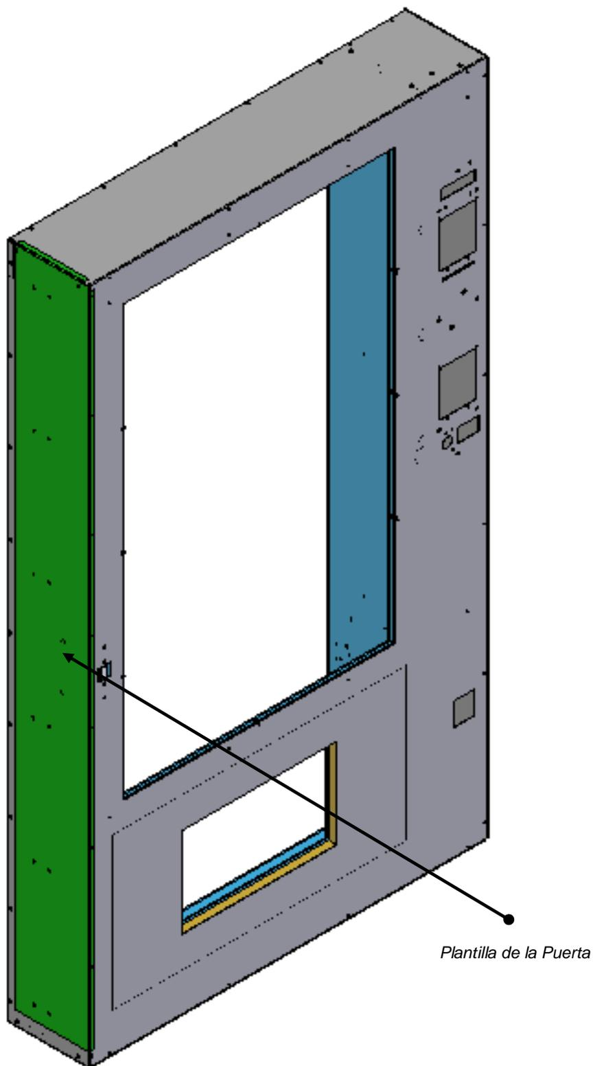
5. Retire las plantillas y agrande los barrenos con la broca para metal de 1/4". Sólo perforo la lámina exterior.
