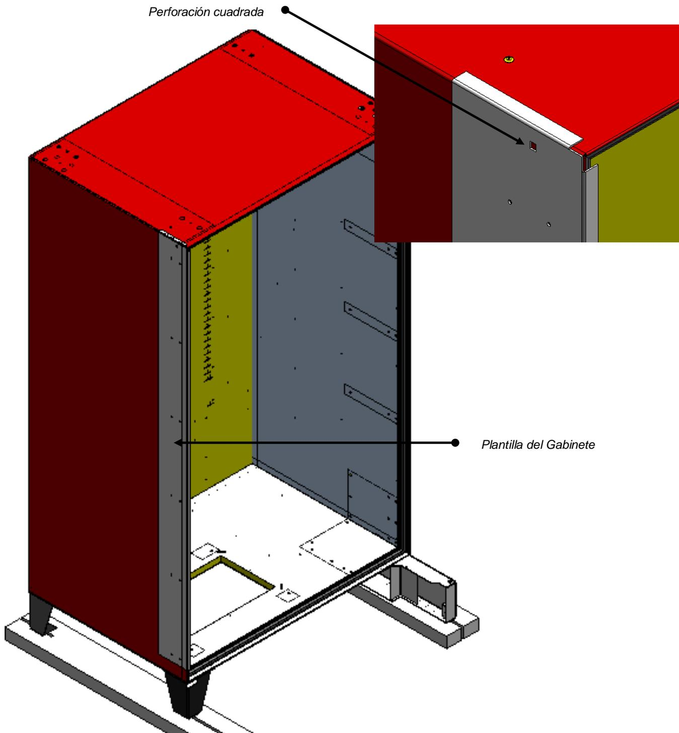
4. La plantilla de la puerta es aquella que no tiene una perforación en forma de cuadro. Coloque la plantilla de la puerta por la esquina superior derecha del lado izquierdo de la puerta con los dobleces apoyándose sobre la parte alta y lateral de la puerta como se muestra. Utilice la broca para metal de 1/8" para hacer los 12 barrenos que hay en la plantilla. Sólo perfore la lámina exterior de la puerta.
