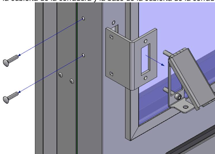
7. Utilizando la broca para metal de 3/8" agrande los barrenos frontales que sostienen la cubierta de la cerradura para que tengan un diámetro de 3/8".
