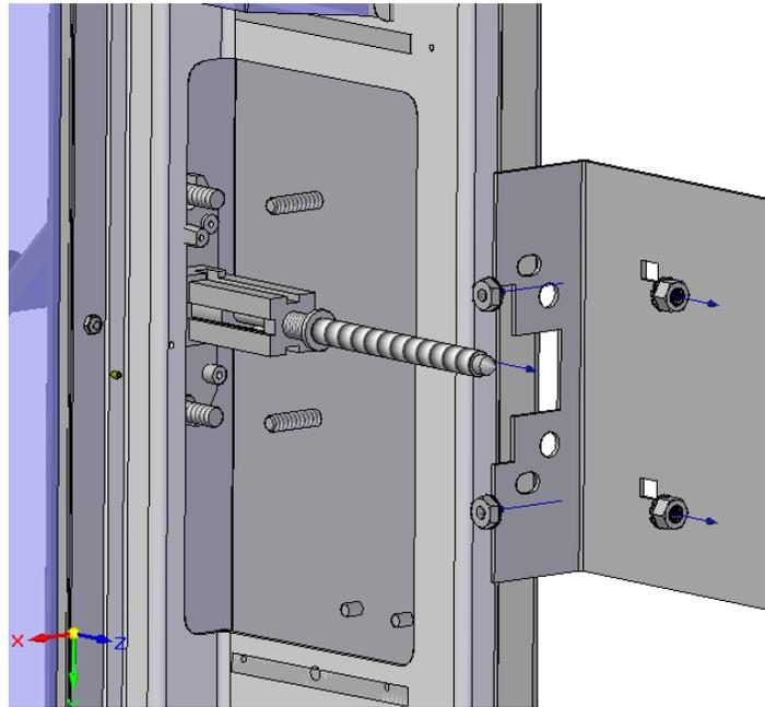
10. Coloque la nueva Cubierta de Cerradura junto con dos rondanas y dos tuercas de 3/8" con rondana de seguridad.
