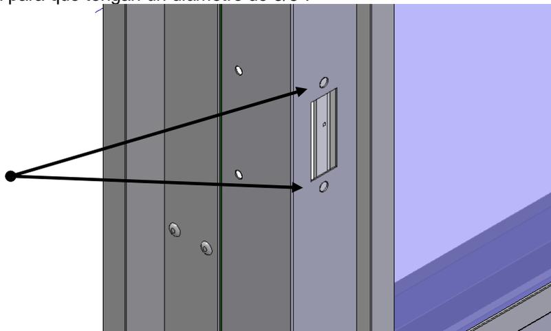
8. Coloque la nueva Base de la Cubierta de la Cerradura de 1/4" con los dos tornillos que ya se tenían previamente, cabeza redonda o de coche 5/16"<sup>8</sup>.
